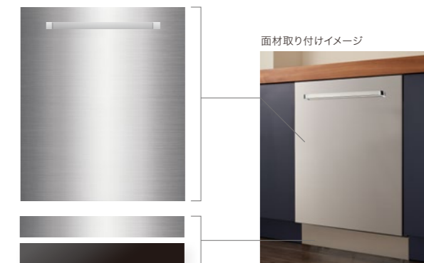
面材(ステンレスハンドル付) ステンレス【HL仕上】:幅594mm×高さ704mm×厚さ18.5mm ハンドル:幅412mm×高さ22mm×奥行き37mm ハンドル厚さ12mm 巾木 ステンレス【HL仕上】:幅594mm×高さ75mm×厚さ18.5mm 黒ポリ【黒ツヤ消し】:幅594mm×高さ75mm×厚さ18mm
