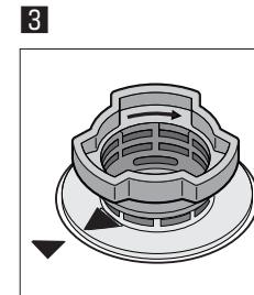
3 フィルターを組み立て、サンプに戻した後に矢印が向き合うまで回す
